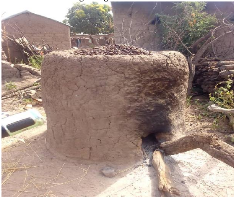
Photo1 : Séchage des graines dans le four à Dèbèlin
